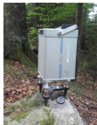
Le dispositif gravimétrique installé sur le bassin versant du Strengbach est hybride : il comprend les mesures d'un microgravimètre, déplacé sur seize stations, rattachées à la mesure continue d'un gravimètre supraconducteur de référence.
